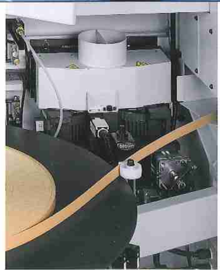
Fügefräsaggregat Perfekter Schnitt und hohe Standzeit durch Diamantwerkzeuge für eine optimale Leimfugenqualität.
