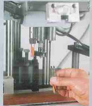
ENGANCHE RÁPIDO DE BROCAS RAPID CONNECTION BIT
