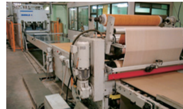
Kaschierstation für ein- oder beidseitiges Folienauflegen Laminating station for single- or double-sided lay-up of foils
