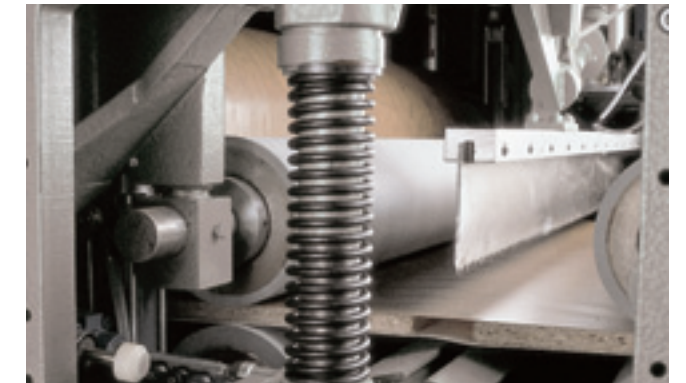
Folientrennung: elektronisch gesteuertes Schwingmesser für geringsten Werkstückabstand Foil trimming: electronically controlled swinging knife for a minimum space between the boards
