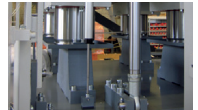
Fehlbelegungssicherung zur Vermeidung von Beschädigungen der beweglichen Heizplatte bei fehlerhafter Auslegung der Presse. Safety device to prevent faulty loading of the press and thus damage to the mobile heating platen.
