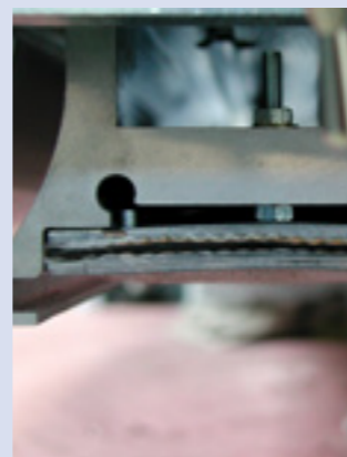
acp - : Pneumatisch abgestützter Druckbalken
