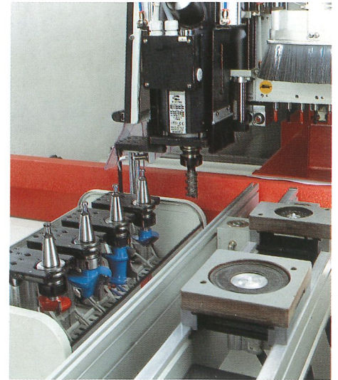
Magazzino utensili. Elettromandrino con utensile agganciato.
