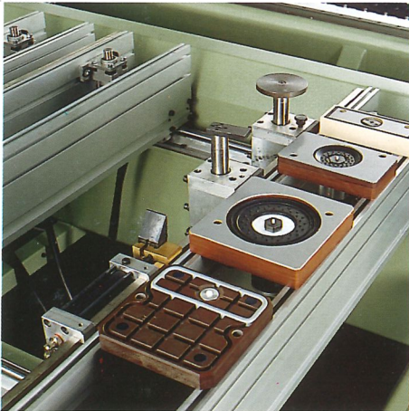
Vari dispositivi di bloccaggio pannello, blocchi ventosa, pressori verticali e orizzontali.
