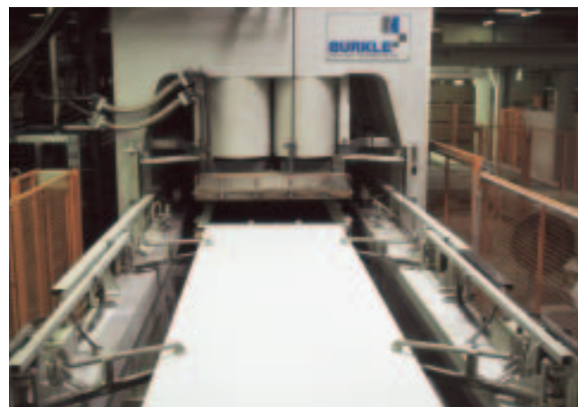
3 Pressenbeschickssystem für 180 Takte pro Stunde 3 Press loading system for 180 cycles per hour
