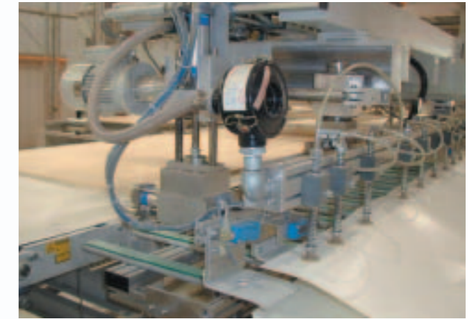
7 Filmzieh leiste mit Ausrichtung 7 Film feeder with alignment
