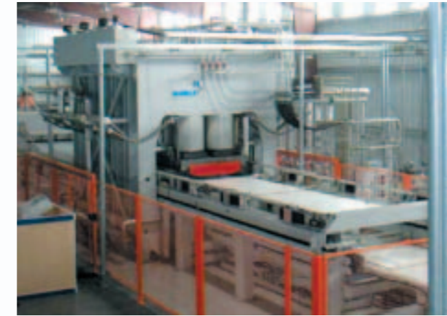
6 KT-Press e mit Beschick system 6 Short-cycle press with loading system
