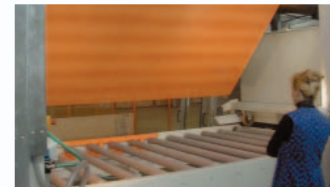
6 Ab Stapelung mit Inspektion der Plattenunterseite 6 Stacking with inspection of the board's underside
