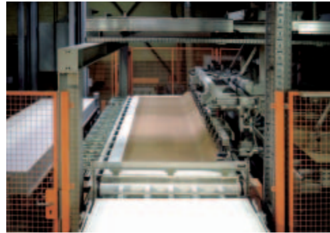
2 Automatisches Filmziehen aus 2-Etagen-Vorratsregal 2 Automatic feed of films from a 2-opening magazine
