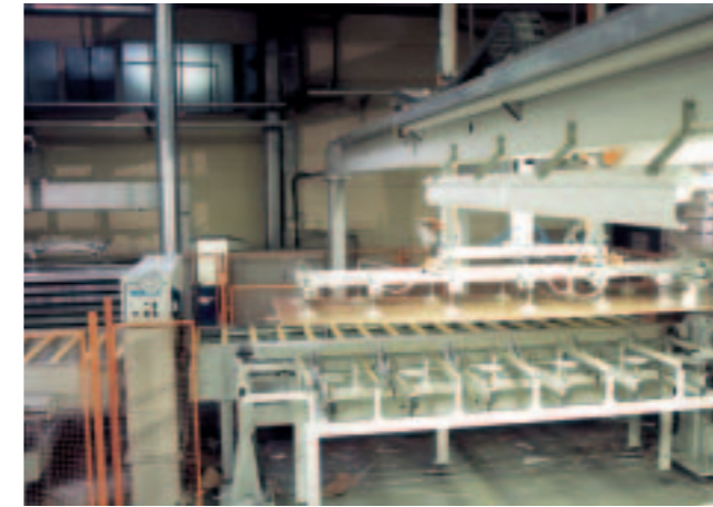
5 Abstapelung und Inspektion der beschichteten Platte 5 Stacking and inspection of the laminated board
