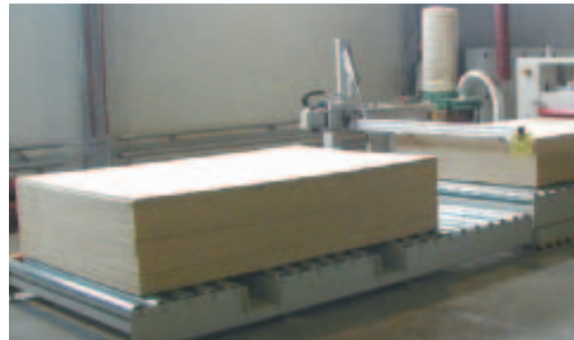
1 Automatischer Einschub und Entstaubung der Trägerplatten 1 Automatic push-feeder and dust removal from the boards
