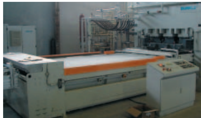
3 KT-Pressen mit Tablettbeschickung 3 Short-cycle press with tray feeding
