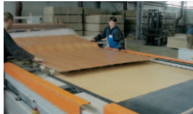
2 Plattenlegevorrichtung: Automatische Plattenlegevorrichtung und manuelles Legen des Melamin-papieres 2 Lay-up device: Automatic board lay-up device and manual laying-up of the melamine paper
