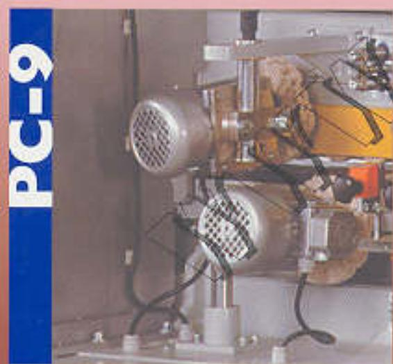
**Grupo Cepillos:** Compuesto por dos motores independientes para la limpieza / Abrillantado del canto, con los Motores inclinables.
