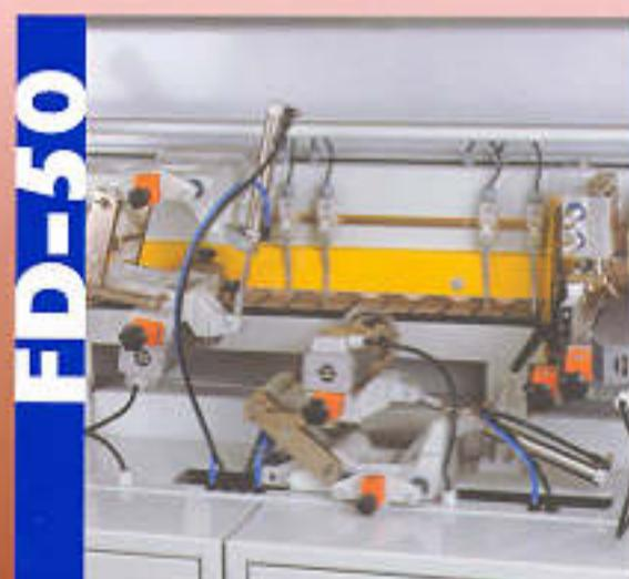
**Grupo Ribeteador de Formas:** Compuesto por dos motores los cuales refunden tanto la parte superior como la inferior de los Paneles en sus aristas y en formas de bisel o radios sin tener que regular al pasar de una forma a la otra.
