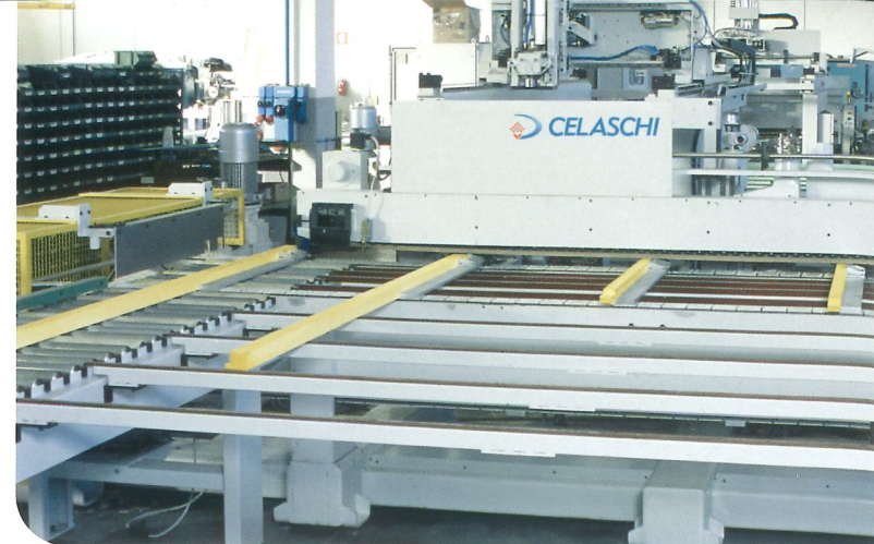
Tenonatrice - lavorazione contemporanea di lunghezze diverse Tenoner - simultaneous machining of different lengths Schlitzmaschine - gleichzeitige Bearbeitung längenunabhängig Espigadora - elaboración contemporánea de longitudes diferentes. Tenonneuse - usinage simultané de longueurs différentes
