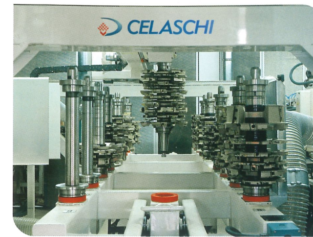
Magazzino utensili automatico Automatic tools magazine Automatisches Spindelmagazin Almacen utensilios automatico Magasin outils automatique
