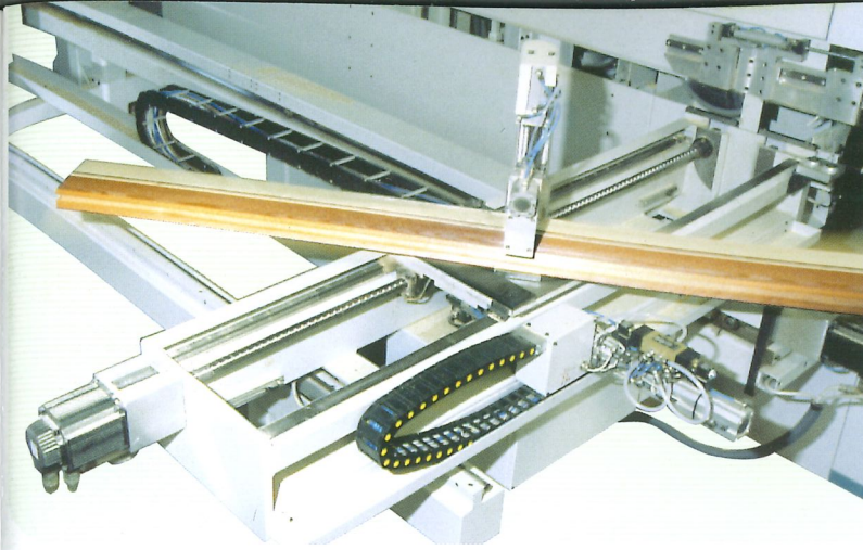
La robustezza del carro permette la lavorazione in doppio Strong construction of the carriage allows to machine in double Die robuste Bauweise des Schlittens erlaubt eine paarweise Bearbeitung La robustez del carro permite la elaboración doble La robustesse du chariot permet l'usinage de deux pièces simultanément
