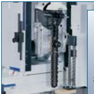
Particolare del gruppo porta catena. Detail de l'ensemble porte-chaîne. Front view of chain-holder unit. Detailansicht des Kettenaggregates.
