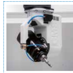
Sistema di lubrefrigerazione Flood cooling system
