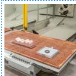
Le Tavole APC consentono carico e scarico all'esterno dell'area di lavoro
