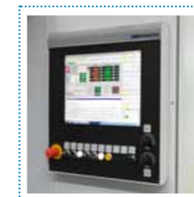
Controllo numerico: possibilità di scelta tra CNC OSAI Open M o GE FANUC Serie 31i-B5
