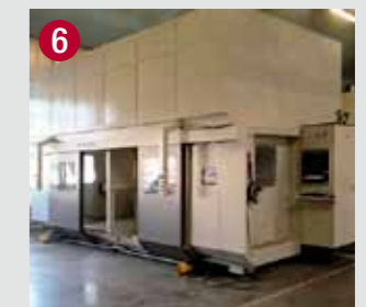
6 Cabina integrale per il contenimento polveri e la diminuzione della rumorosità Full enclosure for dust control and noise abatement
