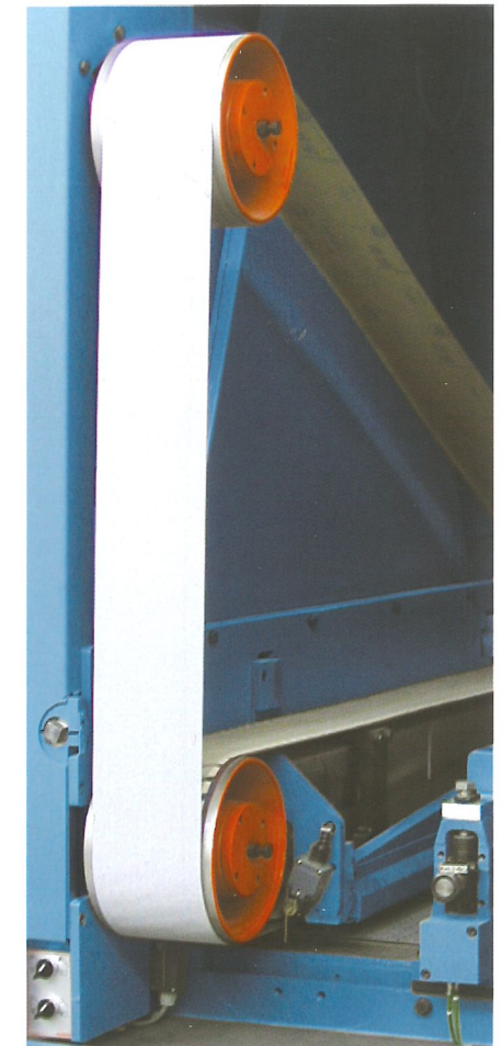
Das Querschleifband mit drei Antriebstrummeln besitzt keine unterschiedliche Geschwindigkeit zwischen Drucklamellenband und Schleifband.
