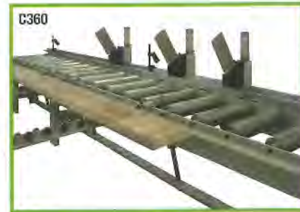
Fases de la expulsión: 1- tabla posicionada contra el tope 2- empuje de los brazos 3- tabla expulsada
