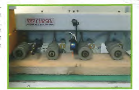
▲ Gruppo di lettura difetti (su richiesta installabile prima della troncatrice, a distanza variabile) Defect reading unit (it can be installed before the cross-cut saw if requested, variable distance) Grupo de lectura de defectos (a petición instalable antes de la tronczadora a distancia variable)
