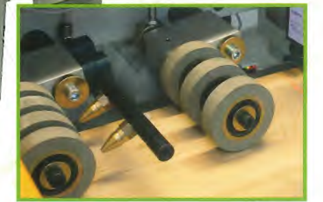
▲ Soffiatori silenziati comandati dal PLC Silenced blowers controlled by PLC Sopladores silenciados de CN
