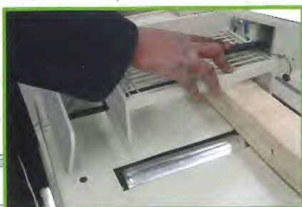
Most safety: cutting control with dual consent. Securities sealed with lead. Máxima seguridad: mando de corte con doble pulsación sincronizada. Dispositivos de seguridad precintados.
