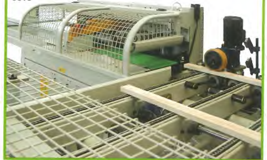
AOCS1 con troncatrice TRV 1700A AOCS1 with cross-cut saw TRV 1700A AOCS1 con tronadora TRV 1700A
