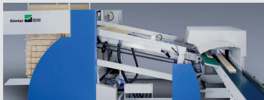
**Sistemi di lettura scanner** rilevano in un batter d'occhio e in modo completamente automatico le caratteristiche più significative del pezzo come nodi, strappi o venature e trasferiscono istantaneamente questi dati, anche a normale ritmo produttivo, ad elementi meccanizzati e fino a 4 OptiCut ad alto rendimento.
