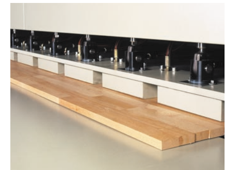
Einzelne, gefederte Presselemente hinten garantieren den gleichen Pressdruck auf allen Leimfugen (auch bei Mehrbahnen, Leimverschmutzung oder Dickentoleranzen).
