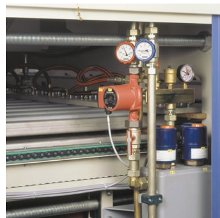
Die integrierte Warmwasserheizung (wahlweise auch extern oder mit Thermoöl oder mit Hochfrequenz).
