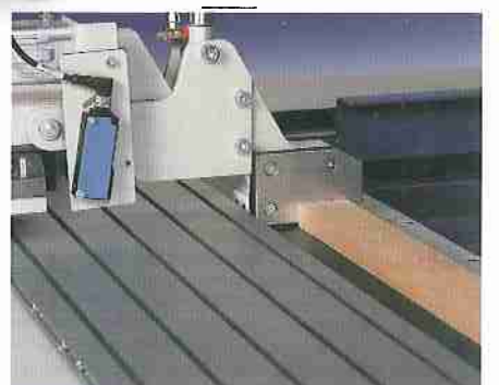
Schwerer Positionsanschlag, schwenkbar. Schnell manuell oder elektrisch verstellbar.
