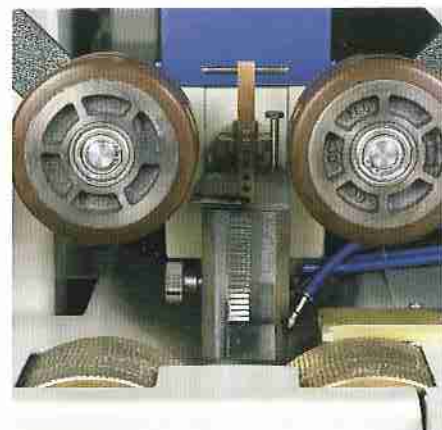
Leim wird präzise auf das Werkstück aufgetragen.
