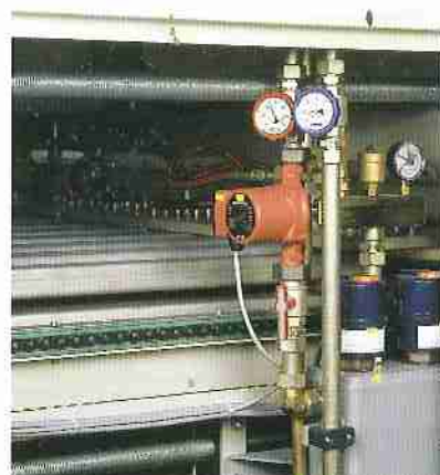
Die integrierte Warmwasserheizung (wahlweise auch extern oder mit Thermoöl oder mit Hochfrequenz).
