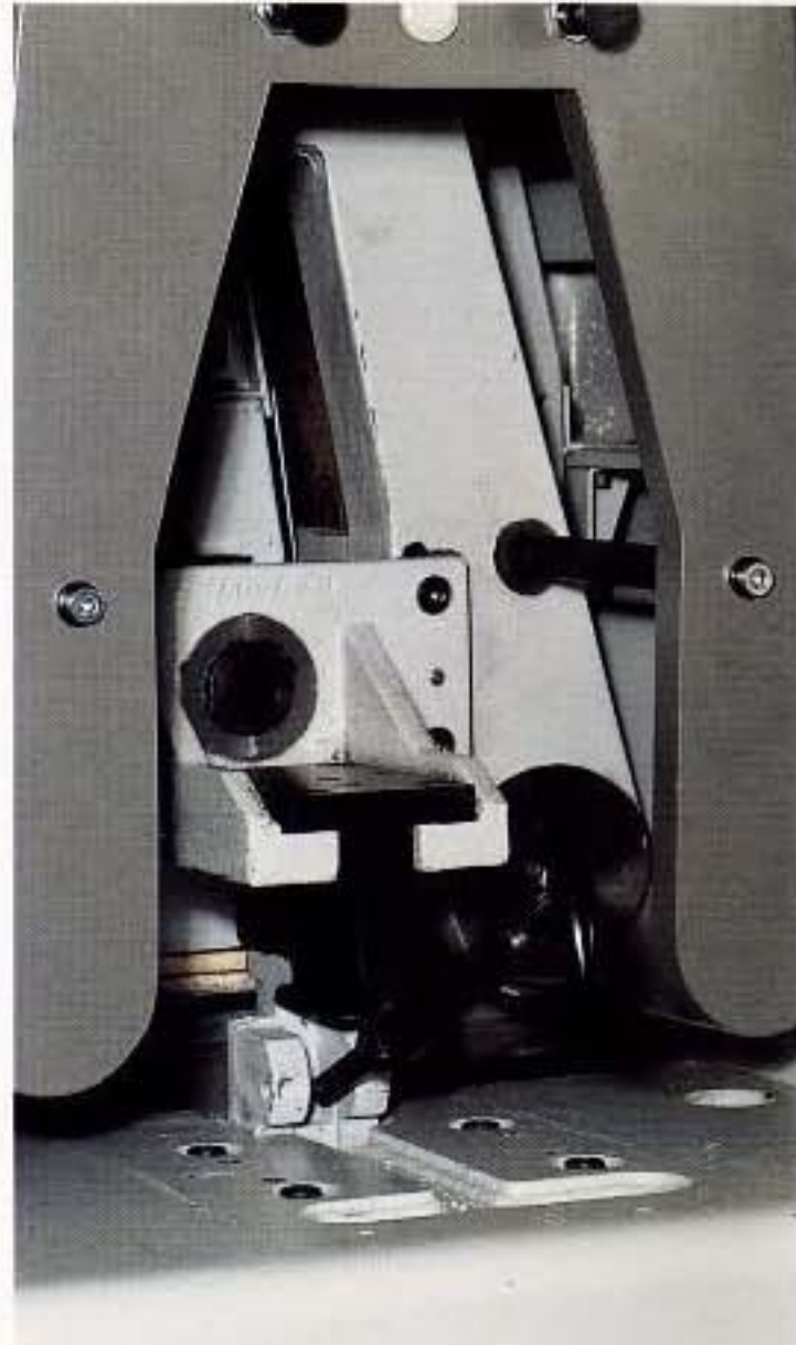
ALS: verriegeltes Schnellbefestigungssystem «ALS»: quick locking system closed
