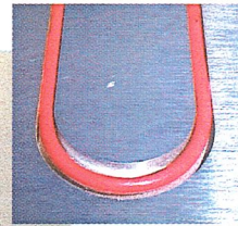
Detailausschnitt des ELKOM-Heizleitersystems in den CNC-gefrästen Nuten der Aluminium-Grundplatte.
