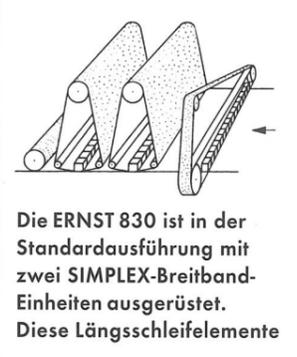
Die ERNST 830 ist in der Standardausführung mit zwei SIMPLEX-Breitbandeinheiten ausgerüstet. Diese Längsschleifelemente
