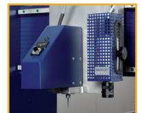
Die EasyWorker MasterPro ist eine multifunktionelle Fräsmaschine der Mittelklasse. Diese Maschine arbeitet mit einem robusten und präzisen Zahnstangenantrieb, welcher Geschwindigkeiten bis zu 19.000 mm/min möglich macht.
