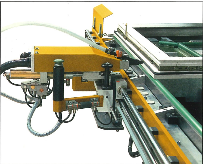
Verfahrbare Vorschubschrauber mit autom. Schraubenzuführung
