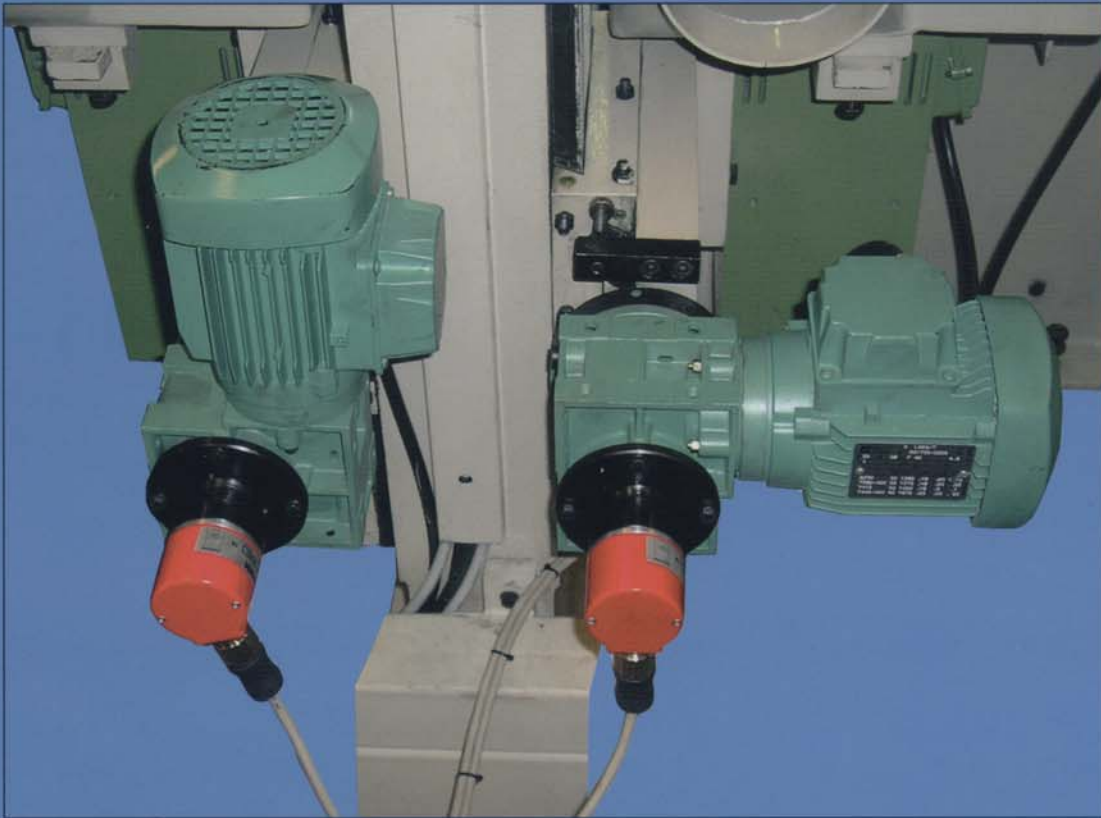
Regulación programada de husillos, lectura en display Motor-driven spindles with programmer, digital electronic readings Broches motorisées avec programmateur, lecture sur display
