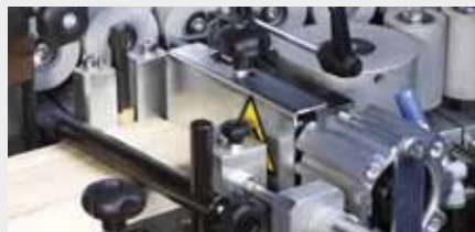
5 Cisaille par guillotine coupe en bout pneumatique (Photo avec magasin pour bandes)
