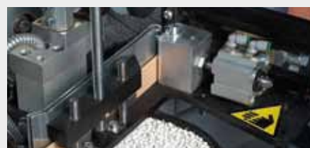
3 Guidage du chant pour chants en rouleaux et à bandes
