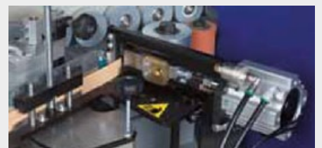
6 Cisaille par guillotine coupe en bout pneumatique
