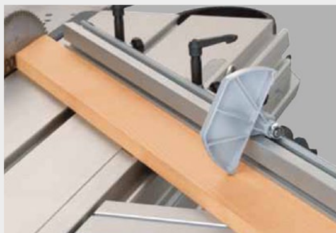
Le guide de coupe d'onglet 1300 mm pour la K 500
