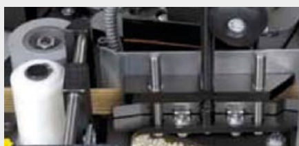
2 Guidage du chant pour matériaux en rouleaux et à bandes
