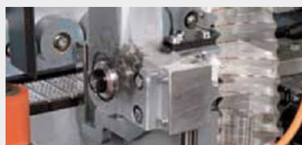
7 Agrégat linéaire de coupe en bout par deux lames de scie
