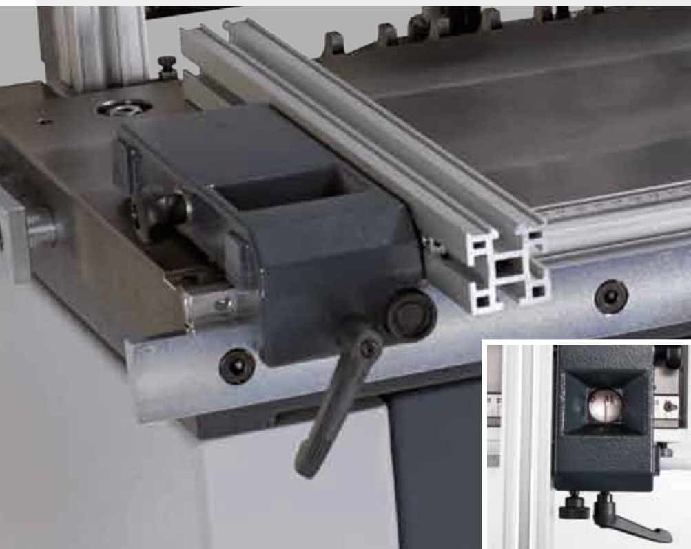
Guides latéraux rigides à gauche et à droite avec un profil de butée 420 mm
