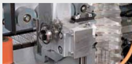
7 Linjärt kapaggregat med två sågblad
