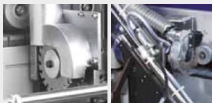
8 Sågaggregat linjär Sågaggregat 45° (Tillval)
