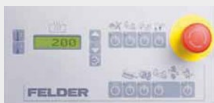
1 Manöverpanel med LCD visning och pekskärm
