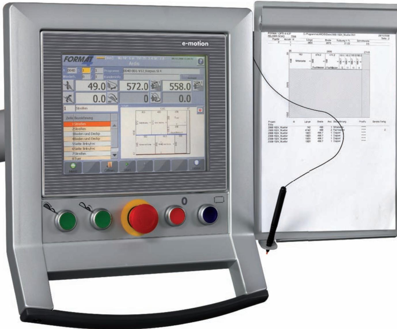
Ab sofort gelingt die Zuschnittoptimierung mit Format-4-Formatkreissägen besonders einfach. Ermöglicht wird dies durch die Integration der Ardis-Schnittoptimierung in das Format-4-Bedienkonzept. Alle Funktionen sind auf der Bedienoberfläche übersichtlich dargestellt. So werden z. B. die Werkzeugbreite und der Saum (Anschnitt) wie auch die laut Stückliste vorgegebene Laufrichtung der Maserung bei Dekorspanplatten – das spart Zeit, Material und damit schlussendlich Geld.
