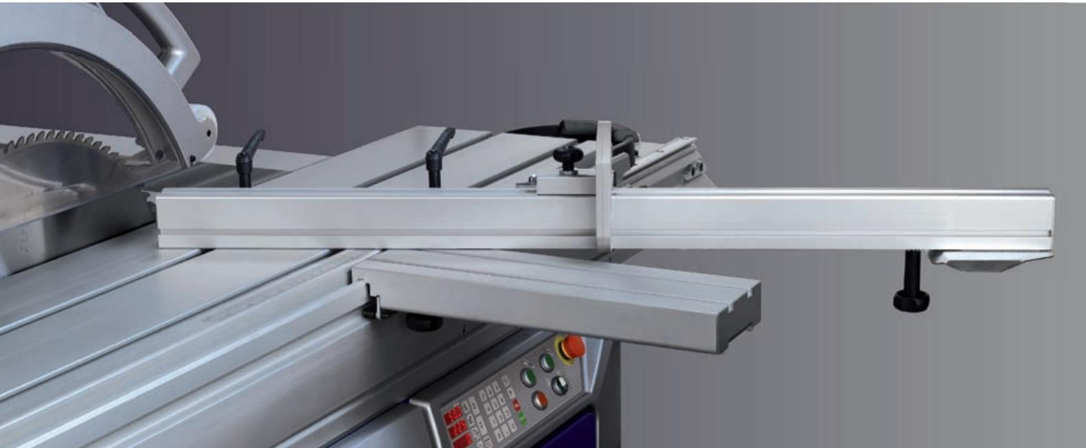
Der Ablänganschlag wird für Gehrungsschnitte zwischen  $+45^\circ$  und  $-45^\circ$  über die im Formattisch integrierte Gradskala eingestellt. Für die werkzeuglose Schnellmontage sorgen T-Nut und seitliche Aufnahme am Formattisch. Die zur Bedienseite stehende Skala und die Ableseoptik am Anschlagbacken gewährleisten präzise Einstellarbeit bis 1100/2050 mm.
