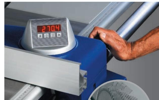
Digitalanzeige für Parallelanschlag mit automatischer Maßkompensation bei geschwenktem Sägeblatt.
