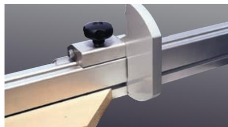
Der Ablänganschlagbacken wurde so konstruiert, dass eine kleine „Nase“ in die dafür vorgesehene Nut am Ablänganschlaglineal eingreift. Daher lassen sich schon auf Gehrung geschnittene spitze Winkel exakt am Anschlagbacken anlegen.
