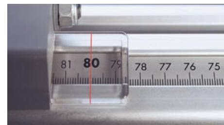
Die Skala der Ablänganschläge ist zur Bedienseite hin geneigt und ermöglicht so bequem das exakte Ablesen des gewünschten Einstellwertes.
