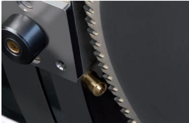
Für die Bearbeitung von NE-Metallen kann Ihre Format-4 mit einer Sprüheinrichtung ausgestattet werden. Dabei wird über den Sprühmittelbehälter Hochleistungsschmieröl über Leitungen direkt zur Sprühdüse am Sägeblatt befördert.
