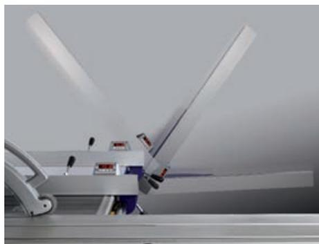
Leichtgängig, fast schwebend wird der Parallelanschlag über die Rundstangenführung am Kreissägetisch geführt. Die Einhand-Schnellklemmung und die Feineinstellung gewährleisten das schnelle und exakte Einstellen des Parallelanschlages auf das von Ihnen gewünschte Maß!
