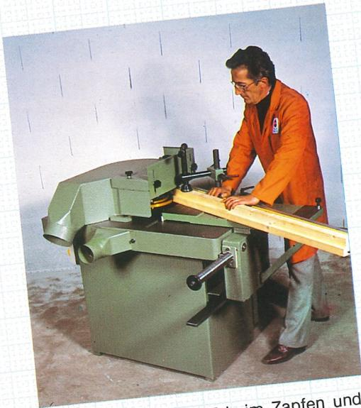
Tischfräse Typ QFT beim Zapfen und Schlitzzen. Rolltisch ausgerüstet mit Sicherheitsvorrichtung und längenverstellbarem Anschlag. Dieser kann auch in 45° Position orientiert werden. Elektrische Sicherheitsvorrichtung bei Haube verhindert höhere Drehzahlen als 3000 u/min beim Zapfen und Schlitzzen.
