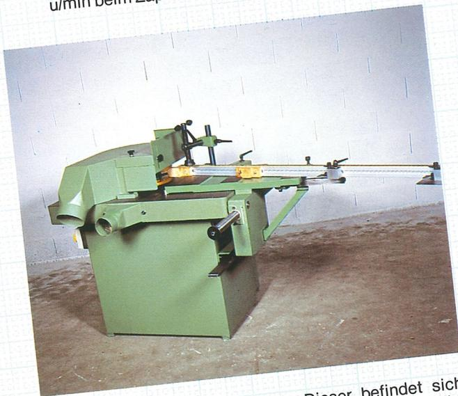
Tischfräse QFT mit Rolltisch. Dieser befindet sich bei normalem Fräsen in einer Position am Maschinenende. Sicherheitshaube und Längenanschlag sind abnehmbar. Ersichtlich 2 Absaugestutzen, davon einer unter dem Tisch.
