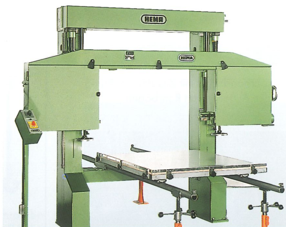
Die eigentliche Horizontal-Bandsäge kann sowohl ober- als auch unterhalb des Schiebetisches angeordnet sein.
