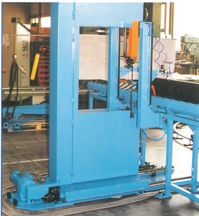
Rohrsäge mit elektrisch angetriebenem Vorschub und spezieller Rohrspannung.
