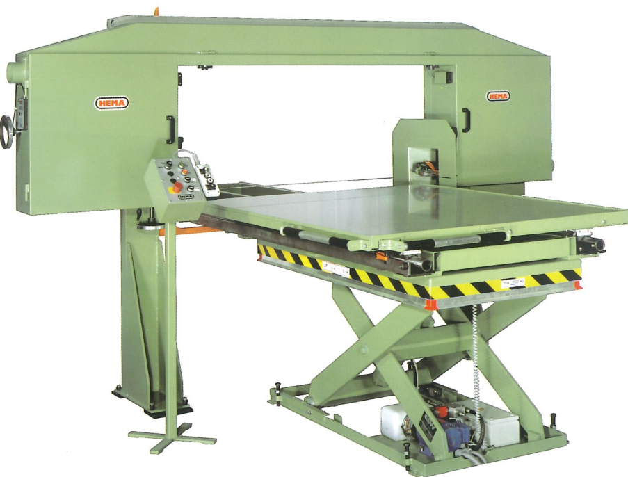
Für bestimmte Einsatzbereiche ist es notwendig, dass der Schiebetisch abgesenkt wird. Hierfür sind Hubelemente lieferbar, mit welchen die gewünschte Schnitthöhe exakt angefahren werden kann.
