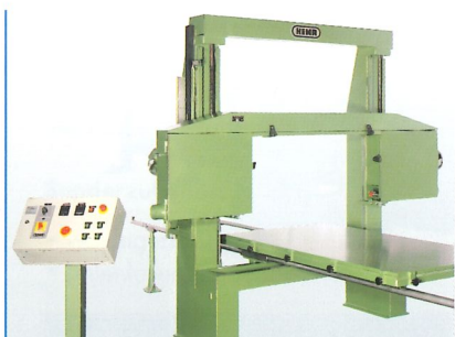
Die Betätigung des Tisches kann von Hand erfolgen, selbstverständlich auch über elektrischen Antrieb mit stufenloser Vorschubsteuerung.
