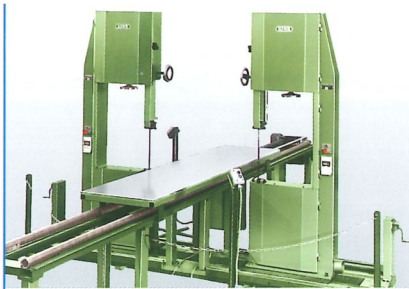
Besäum-Bandsäge für gestapelte Kunststoffprofile
