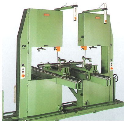
Besäum-Anlage für hochempfindliche Keramikkörper
