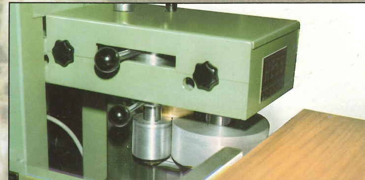
HESS-Leimangabemaschine für einseitigen, vertikalen Leimauftrag. Leimauftragungsgeschwindigkeit 45 m/min.
