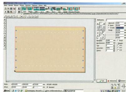
Werkstückbeschreibung werden die NC-Daten automatisch erzeugt. Mit ihnen kann eine Echtzeitsimulation erfolgen, um die Fertigungszeit exakt vorzukalkulieren.
