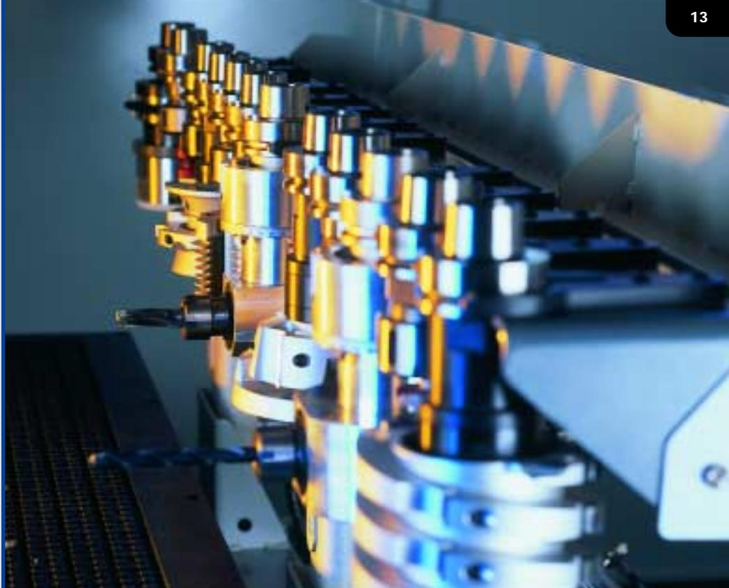
Der Pick-up-Werkzeugwechsler ist am Kopf des Bearbeitungstisches montiert. Im Ruhezustand befinden sich die Werkzeuge staubgeschützt abgedeckt unter dem Niveau des Bearbeitungstisches. Für den Werkzeugwechsel klappt die Schutzhaube weg. Der gesamte Werkzeugwechsler wird pneumatisch angehoben.
