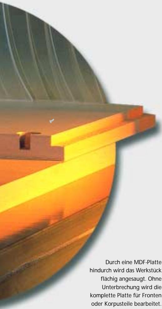
Durch eine MDF-Platte hindurch wird das Werkstück flächig angesaugt. Ohne Unterbrechung wird die komplette Platte für Fronten oder Korpusteile bearbeitet.
