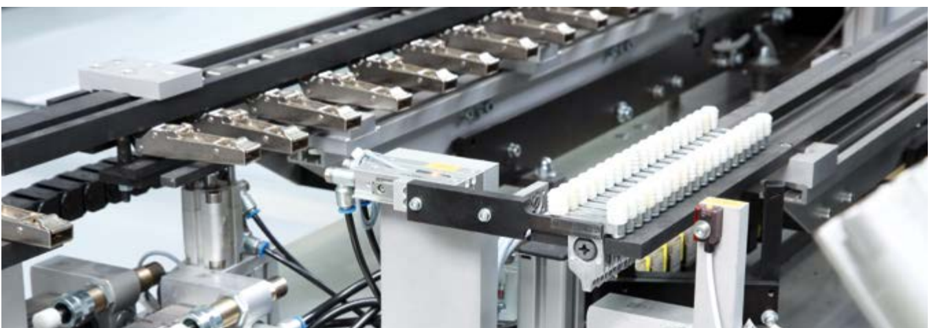
Linearförderstrecken zur Übergabe und Vereinzeln von Beschlägen
