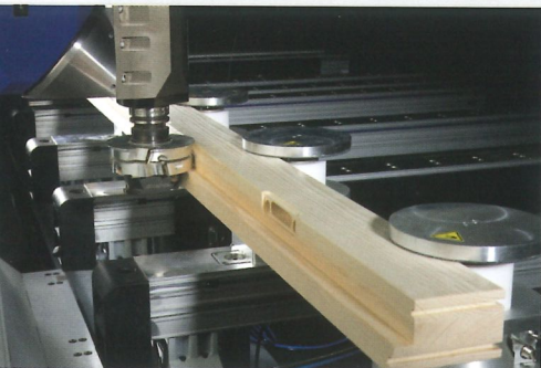
Rahmenteile spannen und profilieren
