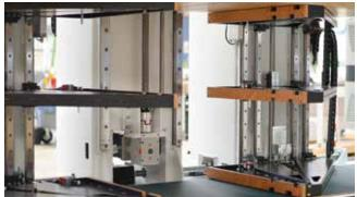
Caras de prensado laterales: las caras de prensado funcionan como una unidad. Las fuerzas de prensado se generan eléctricamente y pueden ajustarse por separado. Se colocan verticalmente mediante una placa de prensado y horizontalmente mediante 3 caras de prensado.
