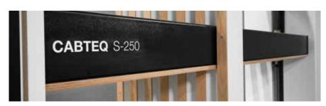
Superficies de prensado con compensación de tolerancia: las láminas de prensado funcionan como una unidad: se colocan sobre gomas y, así, consiguen amortiguación. Al empujar las láminas de prensado sobre el cuerpo al mismo tiempo, la presión se reparte de forma uniforme.
