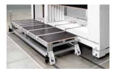
Plataforma de preensamblaje deslizable: la plataforma de preensamblaje facilita la colocación de los muebles a la altura de trabajo de la prensa.
