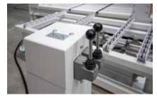
Manejo del elevador de cuerpos: con tan solo tirar de la palanca, el elevador de cuerpos eleva el cuerpo ya prensado.
