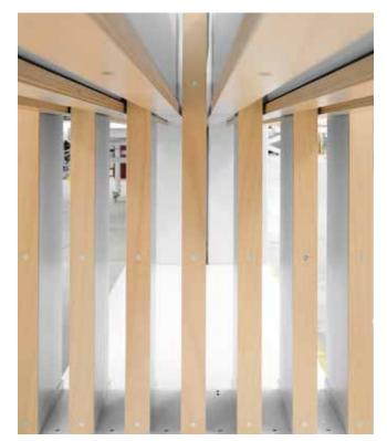
Superficies de prensado con compensación de tolerancia: las láminas de prensado funcionan como una unidad: se colocan sobre gomas y, así, consiguen amortiguación. Al empujar las láminas de prensado sobre el cuerpo al mismo tiempo, la presión se reparte de forma uniforme y las tolerancias en el cuerpo se amortiguan mejor.
