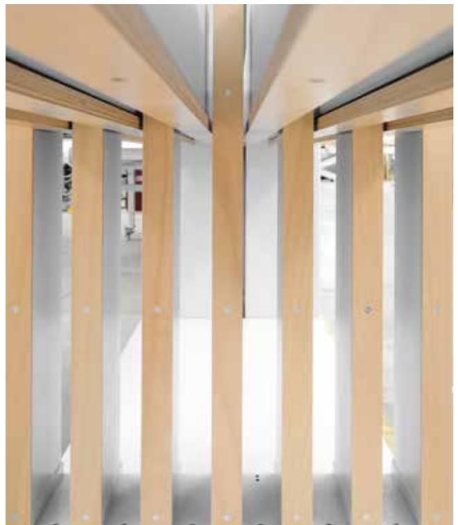
**Superfici di pressione con compensazione delle tolleranze:** le lamelle di pressione funzionano come unità, hanno supporti in gomma e sono molleggiate. Grazie al contatto contemporaneo delle lamelle con tutta la superficie del mobile si ottiene una distribuzione uniforme della pressione. Eventuali tolleranze nel mobile possono essere compensate.
