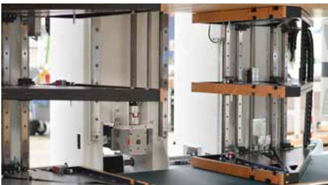
**Spalle di pressione laterali:** le spalle di pressione funzionano come un corpo unitario. Le forze di pressatura vengono generate elettricamente e possono essere variate separatamente. Esse vengono applicate in senso verticale mediante una piastra di pressione e in senso orizzontale tramite 3 rispettive spalle di pressione.
