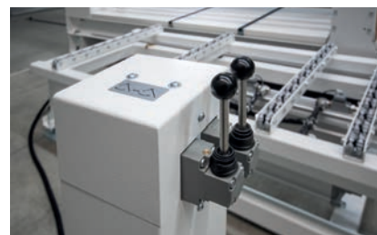
Bedienung Korpusaufrichter: Durch einfaches Ziehen am Hebel richtet der Korpusaufrichter den fertig gepressten Korpus aus.
