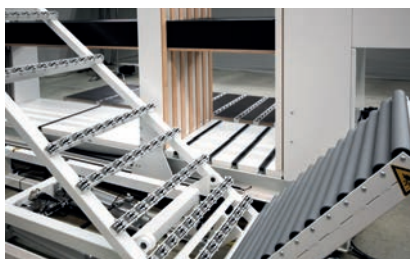
Manueller Korpusaufrichter: Der Korpusaufrichter dient zum Aufrichten und dem Weitertransport von montierten Korpusen.
