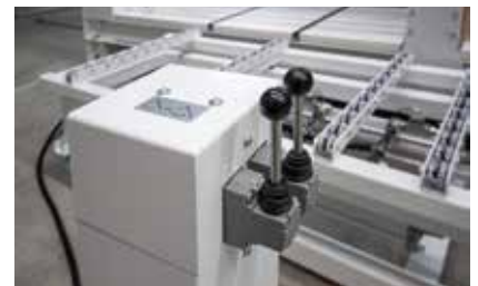
Bedienung Korpusaufrichter: Durch einfaches Ziehen am Hebel richtet der Korpusaufrichter den fertig gepressten Korpus aus.
