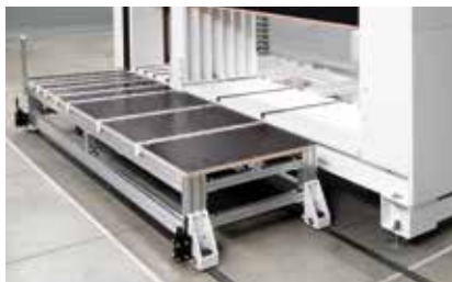
Verschiebbarer Vorsteckplatz: Der Vorsteckplatz ermöglicht ein leichtes Zusammenstecken der Korpusse auf Arbeitshöhe der Presse.
