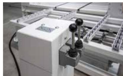
**Utilizzo del ribaltatore per mobili:** semplicemente tirando una leva, il dispositivo solleva il mobile pressato finito.
