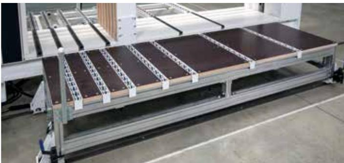
**Verschiebbarer Vorsteckplatz:** Der Vorsteckplatz ermöglicht ein leichtes zusammenstecken der Korpusse auf Arbeitshöhe der Presse.
