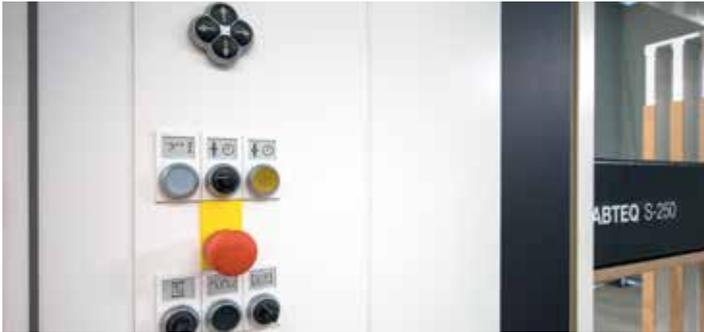
**Intuitive Bedienung:** Die Bedienung ist einfach und erfordert keine Vorkenntnisse. Man muss nur den Korpus in die Presse stellen und den Startknopf drücken. Schon wird der Pressvorgang gestartet. Aufstellen, anschließen und loslegen.
