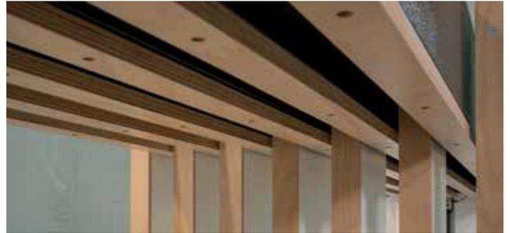
**Pressflächen mit Toleranzausgleich:** Die Presslamellen funktionieren wie eine Einheit, sie sind auf Gummis gelagert und abgefedert. Durch das zeitgleiche Auftreffen der Presslamellen auf den Korpus wird der Druck besonders gleichmäßig verteilt.
