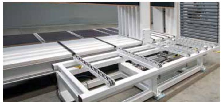
**Manueller KorpUSAufrichter:** Der KorpUSAufrichter dient zum Aufrichten und dem Weitertransport von montierten Korpusen.
