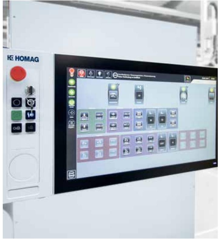
**Einfache Bedienung:** Die Bedienung ist einfach und intuitiv. Integrierte Hilfe- und Assistenten-Funktionen erleichtern das Arbeiten. Einstellungen wie Presszeit oder Pressdruck können schnell und einfach durch den Bediener über einen Touch-Monitor eingegeben werden.
