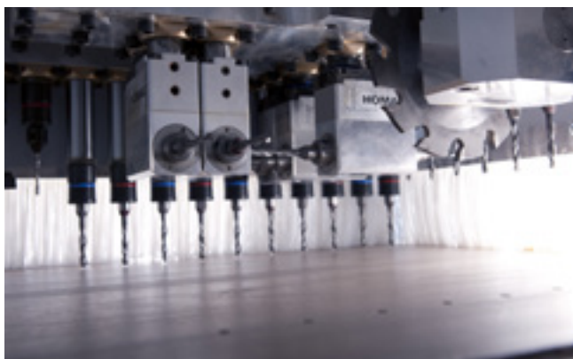
Tecnologia de furação High-Speed com serra de ranhura
