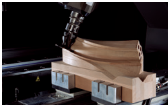
Usinagem de corrimão de escadas
