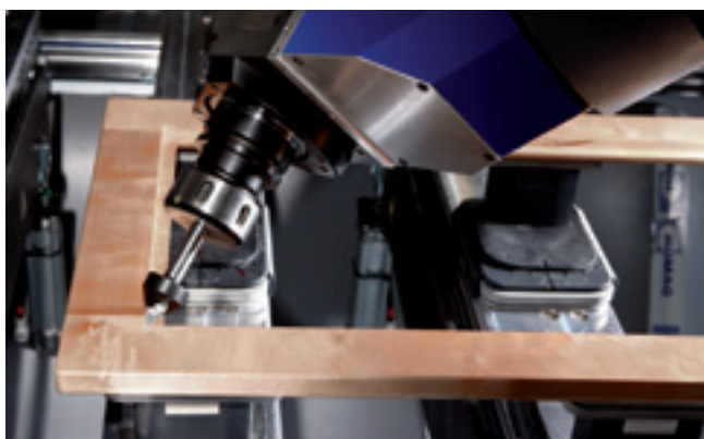
Usinagem de quinas para rebaixo de janela
