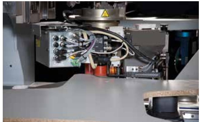
360° Kantenverleimung mit dem powerEdge Kantenanleimaggregat
