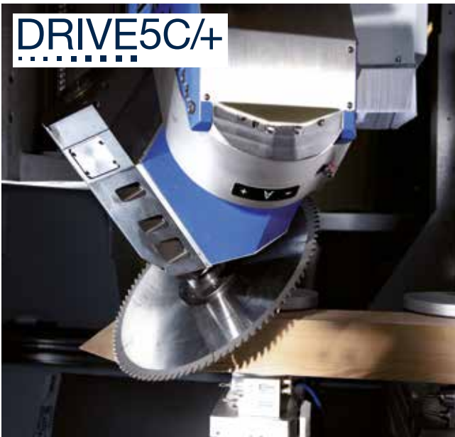
5-Achs-Frässpindel DRIVE5C/+ mit 10 kW Leistung (optional 12 oder 15 kW) und einer geregelten Spindeldrehzahl bis 24 000 1/min für ein hohes Drehmoment bereits bei geringen Drehzahlen.
