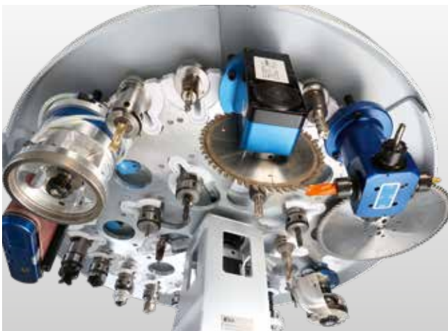
32-fach Tellerwechsler – Anordnung der Werkzeuge in einem inneren und einem äußeren Ring. Für Werkzeuge und Aggregate mit einem Durchmesser von bis zu 200 mm und Sägeblatt mit bis zu 350 mm Durchmesser (im äußeren Ring).
