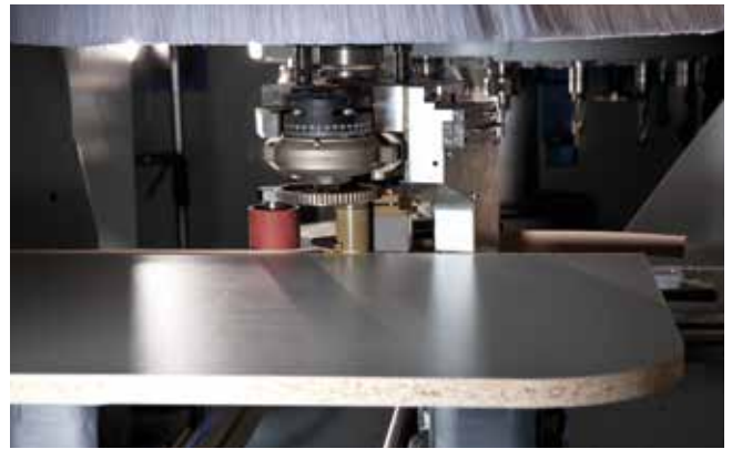
Verleimaggregat easyEdge zum rationellen Anleimen an Formteile
