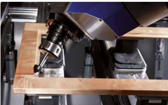
Eckiges Ausspitzen einer Glasfalz-Ecke
