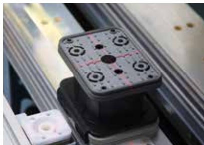
LASER-Positionierhilfe Vakuumsauger werden mit einem Laser-Fadenkreuz angezeigt. Als Positionierhilfe für Freiformteile kann die Werkstückkontur „abgefahren“ werden.
