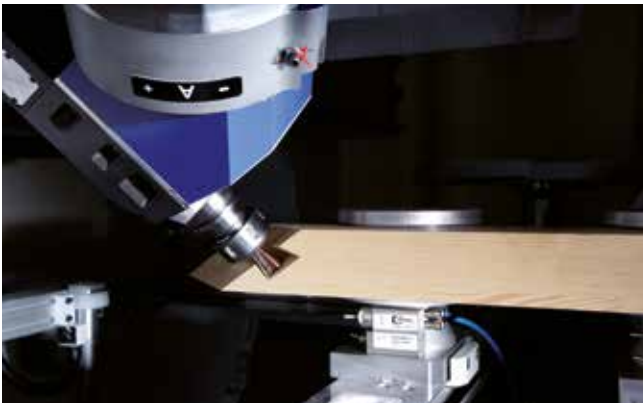
Fräsen einer Gratverbindung für Pfosten-/Riegelkonstruktionen
