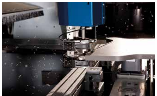
Perfektes Kantenfinish durch getastetes Kombi-Bündigfräs-/Nachputzaggregat
