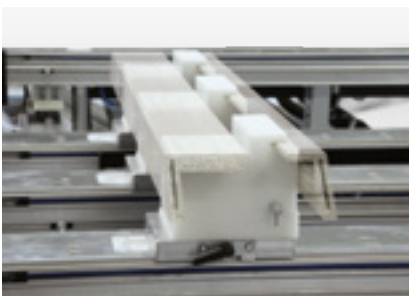
Spannvorrichtung für Bekleidungen: Vakuum-Spannvorrichtung für ein Paar aus Falz- und Zierbekleidung nach Kundenauslegung. Montiert auf eine Grundplattenmodul.
