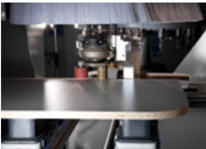
Verleimaggregat easyEdge zum rationellen Anleimen an Formteile
