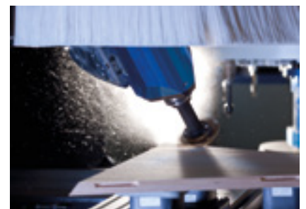
Fräsen schräger Nuten für eine Plattenverbindung
