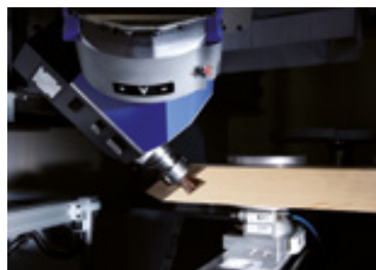
Fräsen einer Gratverbindung für Pfosten-/Riegelkonstruktionen
