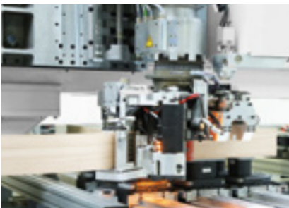
Kantenverleimung für Bauteile bis 100mm Höhe
