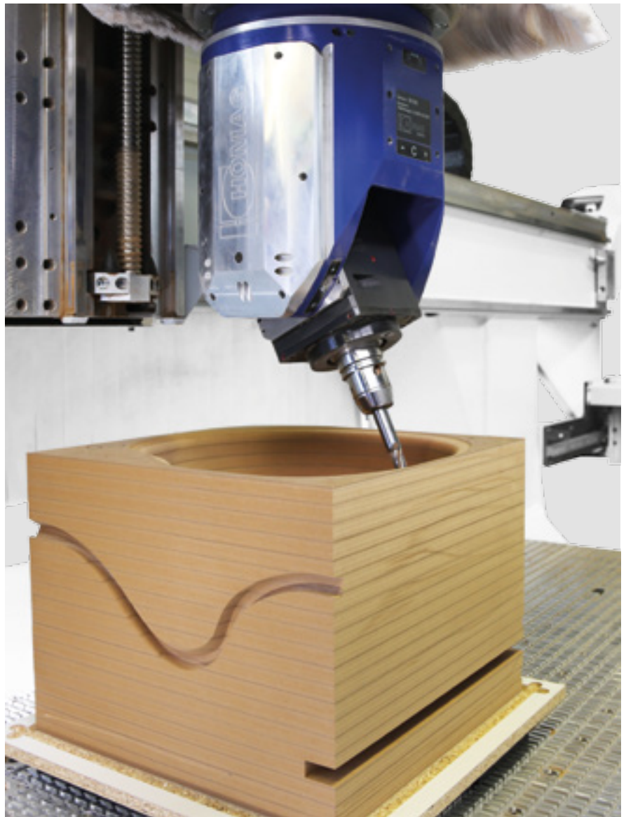
Fräsbearbeitung von Bauteilen mit großer Z- Höhe
