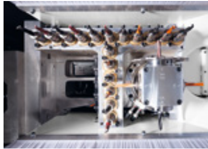
Bohrkopf V17/H4: HIGH-SPEED Bohrkopf bis 7500 1/min mit 17 Vertikalspindeln, Nutsäge und 4 Horizontalspindeln 0/90° schwenkbar. Weniger Bohrtakte inkl. Nuten in X/Y-Richtung.
