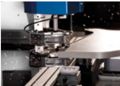
Perfektes Kantenfinish durch getastetes Kombi-Bündigfräs-/ Nachputzaggreat
