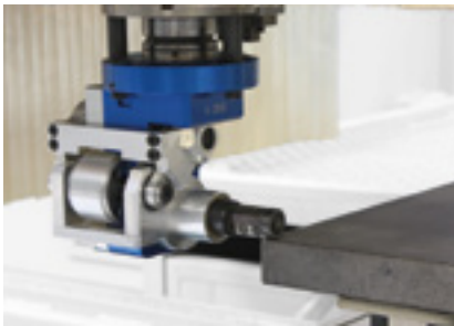
Getastetes Bündigfräsen der Kantenüberstände am Postformingprofil
