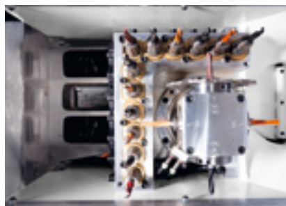
Bohrkopf V12/H4: HIGH-SPEED Bohrkopf bis 7500 1/min mit 12 Vertikalspindeln, Nutsäge und 4 Horizontalspindeln 0/90° schwenkbar. Schnelles Bohren inkl. Nuten in X/Y-Richtung.
