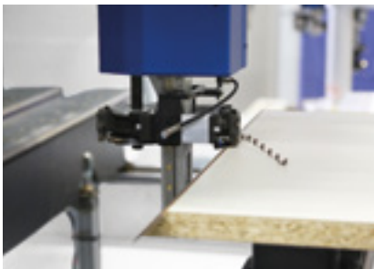
Ziehklingenbearbeitung an Gehrungskante
