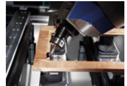
Eckiges Ausspitzen einer Glasfalz- Ecke
