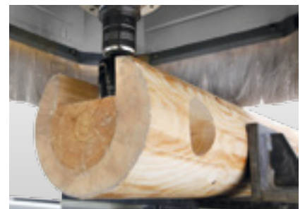
Blockspanner: Angepasste Blockspannvorrichtung für Rundholzelemente.
