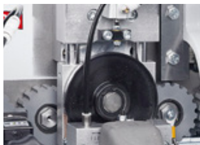
Klebstoffziehklingenaggregat Für das perfekte Finish.
