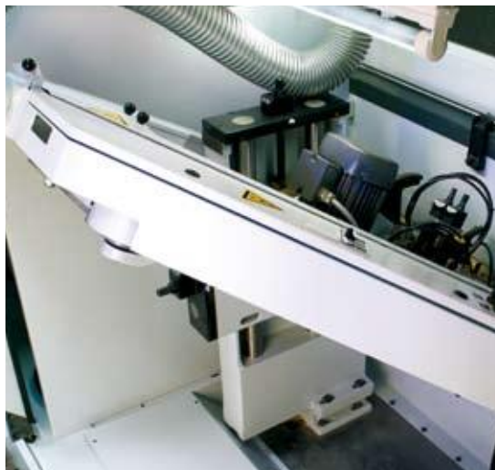
Grupo de lijado de perfiles PS 10/PS 20 Para lijado de perfiles y cantos rectos. PS 20 en la técnica de dos zapatas.
