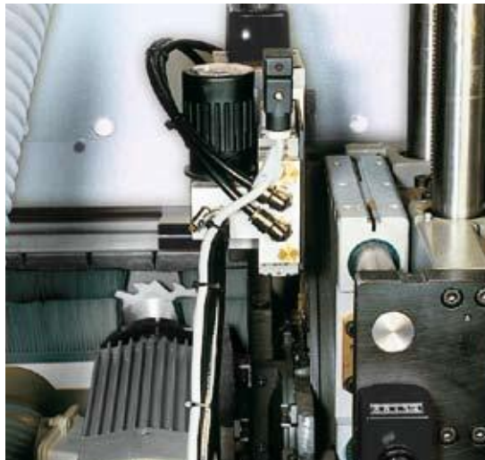
Grupo de fresado universal UF 11 Para ranurado, rebajado y perfilado con motor basculable y controlado.
