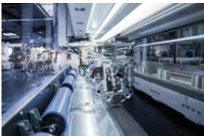
Auf Gummirollen laufende Werkzeuge sorgen für geringere Schneidkräfte und weniger Verschleiß bei bester Schnittqualität und langer Werkzeuglebensdauer.
