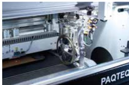
Gracias a las herramientas de corte de desplazamiento automático y equipamiento rápido, es posible producir prácticamente cualquier corte.
