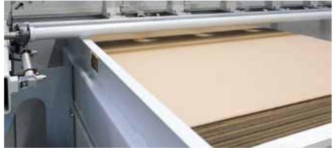
El **sistema de alimentación de láminas individuales automática con mesa elevadora** permite el suministro automático de láminas individuales apiladas.
