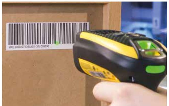
El **control del código de barras** hace que la introducción de datos sea pan comido. Tan solo hay que escanear el código de barras y una referencia de cartón se transferirá a la máquina de corte de cartón con todos los datos necesarios.
