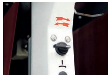
Optional Schnittrichtung ▪ Schnittrichtung wahlweise gegen oder mit der Vorschubrichtung. Verschiedene Schnittrichtungen sorgen für maximale Faserreduktion. Besonders wichtig in Kombination mit Wasser basierten Lacksystemen.
