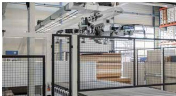
Il **collegamento di macchine di lavorazione** è risolto tramite interfacce standardizzate. Che si desideri il posizionamento direttamente su una sezionatrice, o che una macchina di lavorazione sia collegata al magazzino mediante trasportatore a rulli - lo STORETEQ S-200 aumenta notevolmente il valore aggiunto delle macchine di lavorazione collegate.
