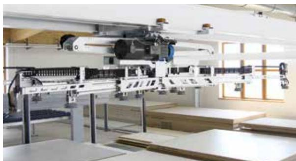
La **traversa a depressione ST71** in geometria X è la dotazione aggiuntiva ideale per lo STORETEQ S-200. La traversa ad autoapprendimento genera autonomamente i dati necessari per la movimentazione dei pannelli, garantendo così una sicurezza affidabile dei processi. L'immissione dati da parte dell'operatore non è necessaria.
