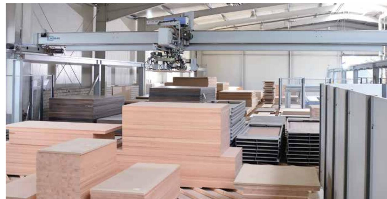
Maggiore ordine e visibilità, maggiore sicurezza! Le posizioni e aree di magazzino possono essere ottimizzate per un funzionamento misto, caotico oppure con un unico tipo di materiale, con una distanza minima fra le cataste (100 mm)
