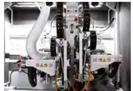
Hochleistungsfräsaggregat SF30 mit automatischer Achsverstellung
