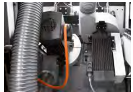
Schwenkbare Hochfrequenzmotoren mit Einzelabsaugung
