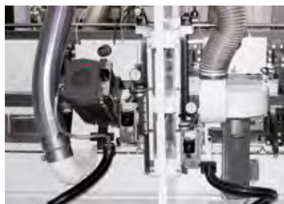
Aggregateführungen mit hochpräziser Einstellvorrichtung und schwenkbaren Hochfrequenzmotoren
